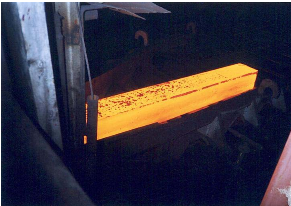
Bild oben: Gut zu sehen der mit Hochdruck „entzunderte“ Knüppel. Die dunklen Punkte sind lediglich Wasserreste auf dem glühenden Stahl.
