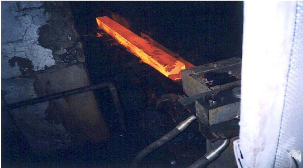
Bild oben: Auf dem „Knüppel“, der soeben den Ofen verlässt, ist der Zunder gut sichtbar.
